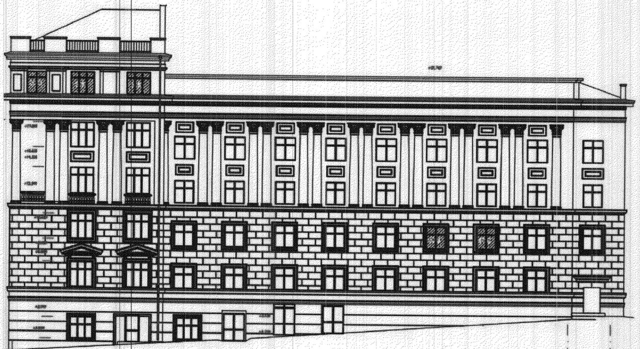
Композиционное решение фасада сформировано: по вертикали условным членением плоскости на четыре части имеющих различное архитектурное построение и декоративное оформление, по горизонтали - равномерно расположенными прямоугольные оконными проемами, колоннами и пилястрами композиционного ордера, угловым левым ризалитом.
