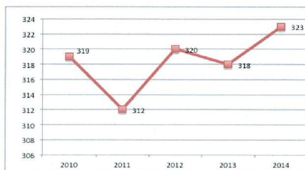
Рисунок 2.4.2 – Изменение годового максимума нагрузки (а, МВт) и объема электропотребления (б, млн кВт·ч) в Центральном энергорайоне
