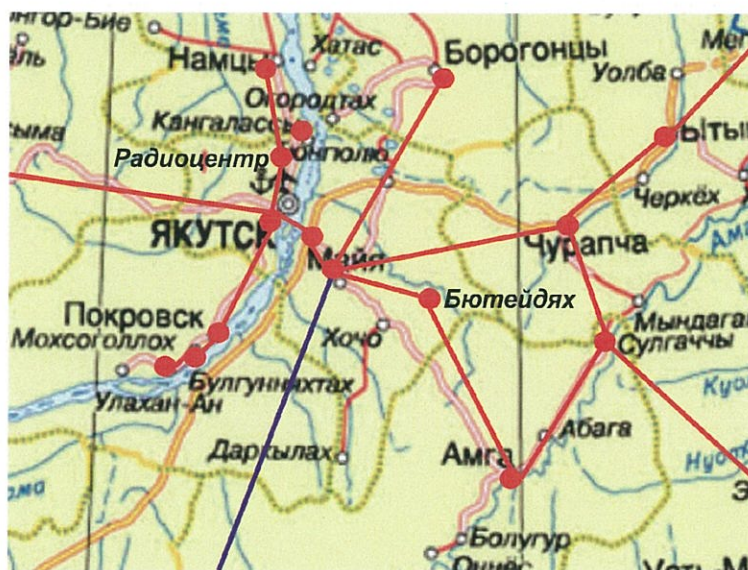
Рисунок 4.9.9 – Фрагмент Центрального энергорайона с включением новых ВЛ 110 кВ Радиоцентр – Намцы и Майя – Бютейдах – Амга
